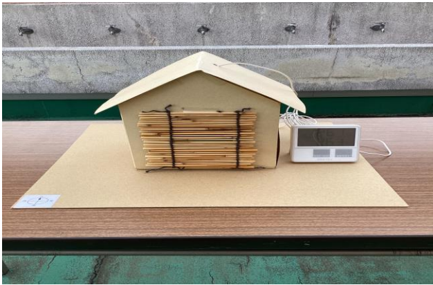
写真4 模型G：窓2か所（南北開口）＋すだれ
