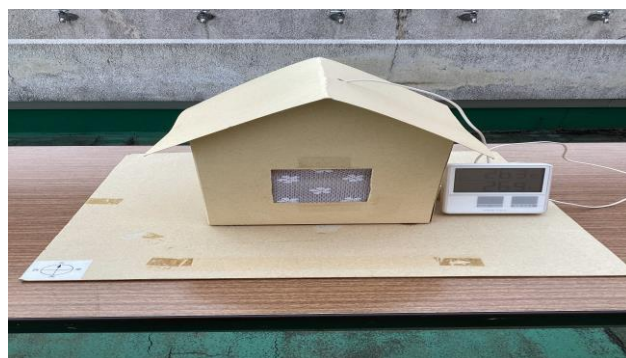
写真3 模型F：窓2か所（南北開口） ＋レースカーテン
