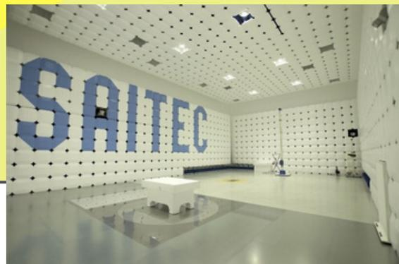
電波暗室電磁波試験測定装置
